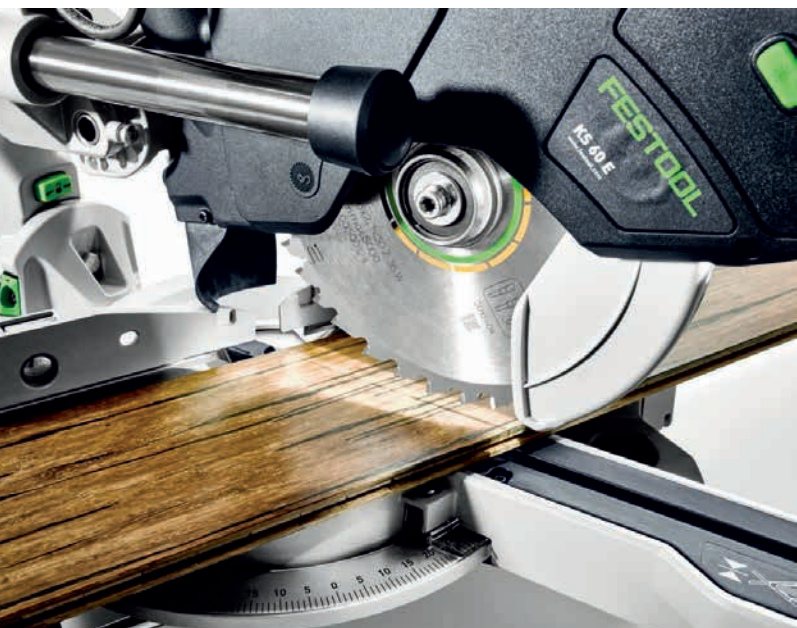
Een lampje boven het zaagblad zorgt voor een slagschaduw daar waar het zal zagen
