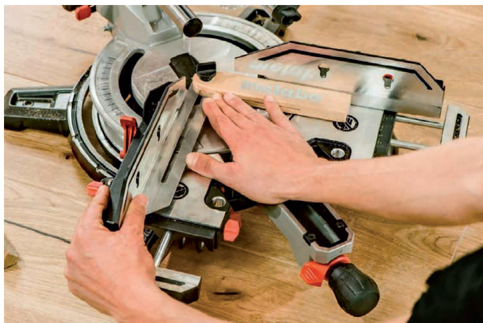
Snel en precies zagen van verstekken is mogelijk dankzij hoekoverdracht vanaf een verstelbare winkelhaak
