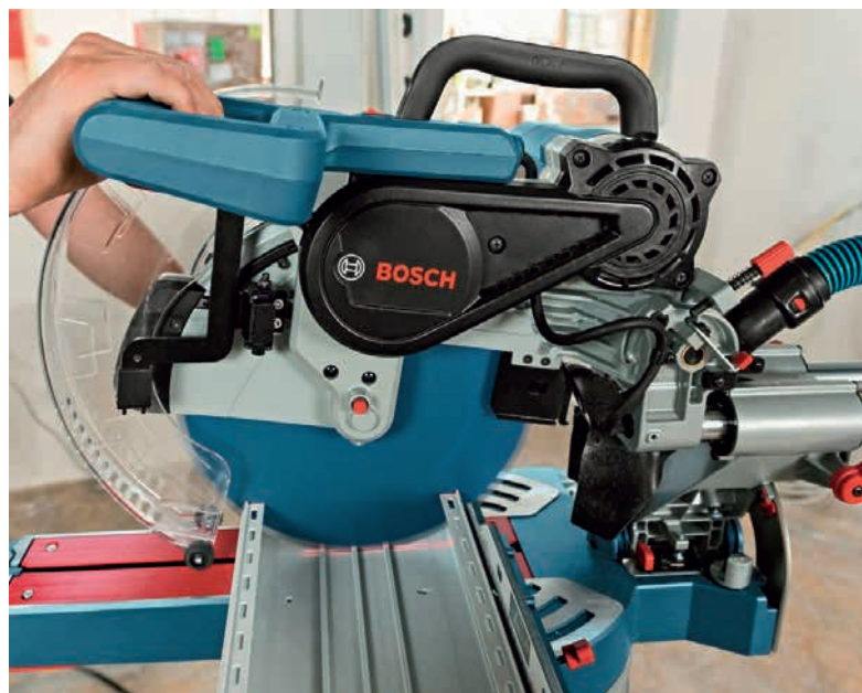
Met de twee lasers verwijdert u met het zaagblad wat zich tussen de lasers bevindt
