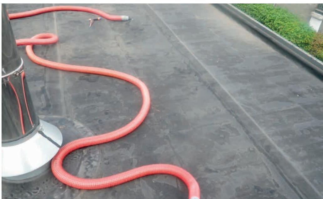
Bij het gebruik van rook zal meteen zichtbaar zijn waar het lek zich bevindt omdat daar uitersnel de rook tevoorschijn komt
