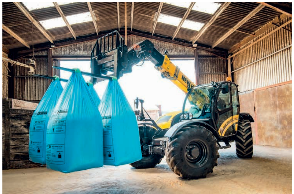
Bij het hijsen wordt de last langs de bovenkant benaderd en opgetild, en gelden enkele specifieke aandachtspunten
